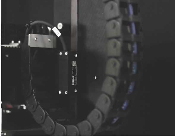
LA11 mágneses útmérő a robotkarba építve
