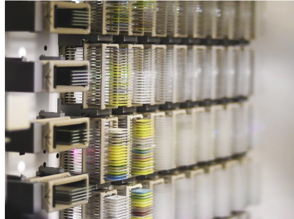
A P1000 berendezés 1000 tárgylemezes kapacitással rendelkezik, és egyetlen műszak alatt képes azok digitalizálására
