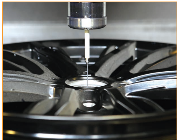
RMP60 midiendo la superficie de montaje de la llanta de aleación
