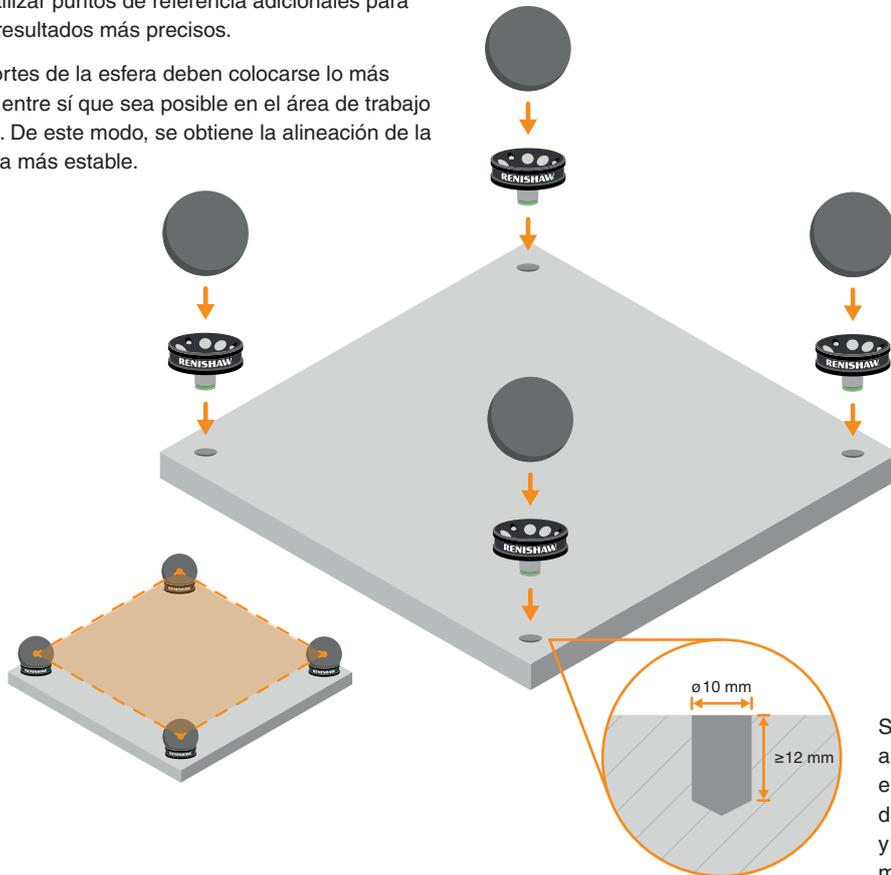
Se recomienda asegurar los soportes en un orificio de taladro de 10 mm de diámetro y una profundidad mínima de 12 mm.
